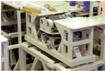
フロントローラユニット移動装置 トレッドに合わせて4段階移動可能
