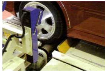
安全装置 車両の飛び出し防止用ローラ
